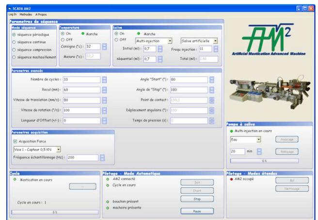
Interface permettant le paramétrage des contraintes imposées à l'aliment, du nombre de cycles de mastication, de la gamme de forces, de la salivation & de la température
