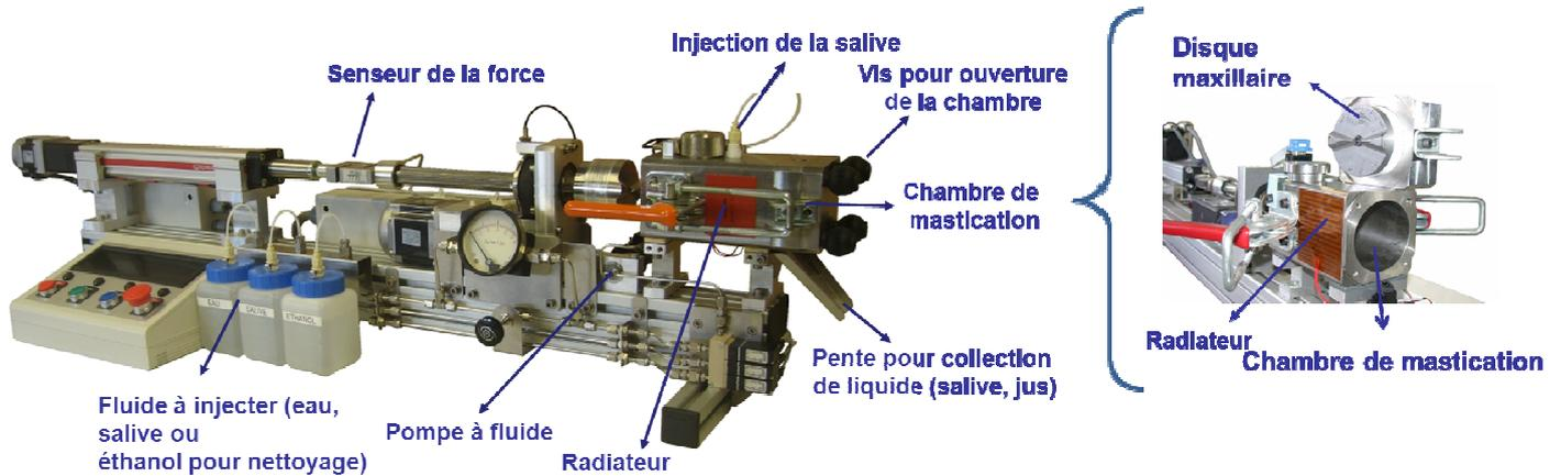
Masticateur artificiel développé par l'équipe de recherche du Centre de Recherche en Odontologie Clinique (CROC) de l'Université d'Auvergne. Le dispositif fait l'objet d'un brevet porté par l'Université d'Auvergne
